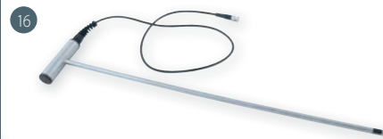
GSF 40 (67 cm) obj. č. 601316 zapichovací snímač (bez teplotního senzoru), pro měření v lisovaných balících do hloubky 60 cm, včetně 1 m připojovacího kabelu, určen pro lisované balíky sena a slámy, obilí
